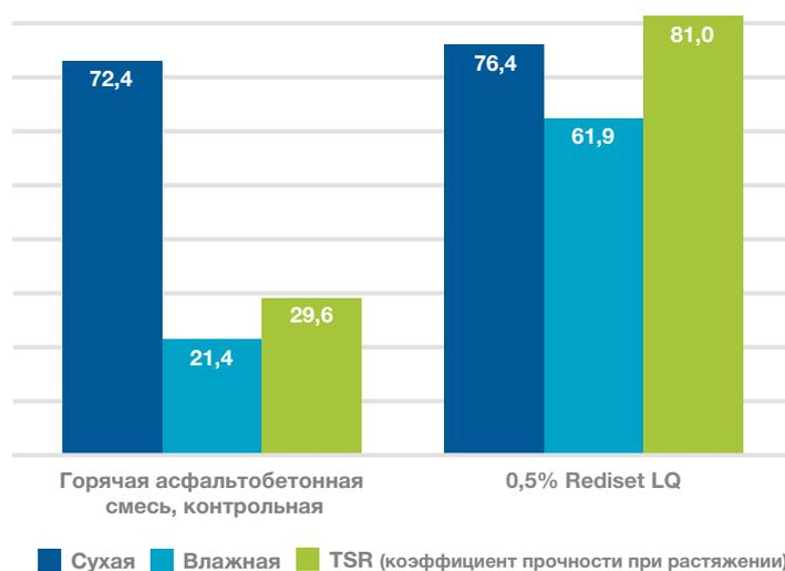
Теплая асфальтобетонная смесь, модифицированная добавкой Rediset® LQ, обладает высокой кондиционной прочностью при растяжении и улучшенным показателем прочности при растяжении по сравнению с обычной горячей асфальтобетонной смесью. Дозировка Rediset® LQ от массы битума марки PG 64-22. Испытания выполняются в соответствии с методом AASHTO T 283.
