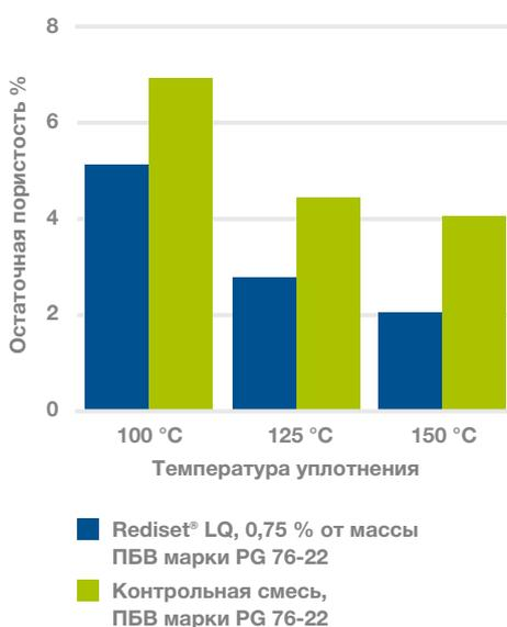
Улучшение уплотнения с помощью Rediset® LQ. Состав смеси: 12,5 мм крупнозернистая смесь Supergravel. Контрольная смесь: горячая асфальтобетонная смесь. Испытания по методу уплотнения Маршалла (AASHTO T 245).
