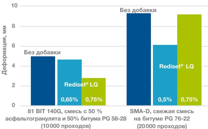
Битум, содержащий Rediset® LQ, обладает более высоким сопротивлением деформации и повышенной влагостойкостью. Данные испытаний на стенде с гамбургским колесом из Чикагской испытательной лаборатории и PaveTech, США. Испытания проводились на основе AASHTO T 324.
